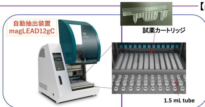
サンプルを1.5 mL tubeに入れ、試薬入りのカートリッジとともに自動抽出装置に架設し、自動単離・抽出を行った。
