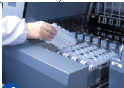
1 プレパック試薬の架設
