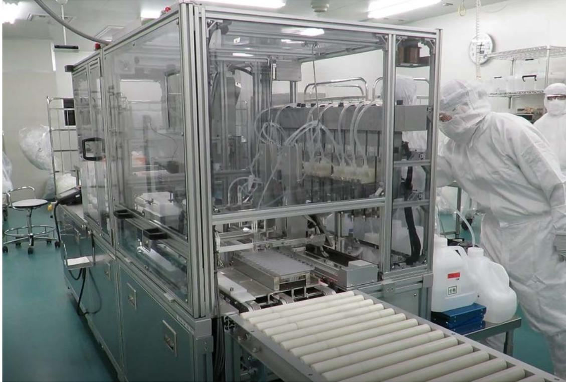
クリーンルーム内試薬製造風景(試薬充填工程)
