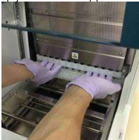
5. Retire el plástico de burbujas, el soporte de fijación del eje Y y la bolsa de gel de sílice.
