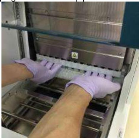
5. Rimuovere il pluriball, la staffa di fissaggio dell'asse Y e il sacchetto di gel di silice.
