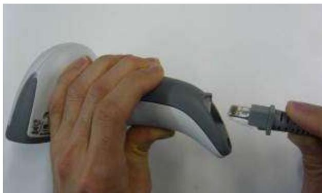
Collegare il cavo dati del lettore di codici a barre allo strumento.
