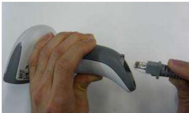
バーコードデータケーブルを本装置に接続します。
